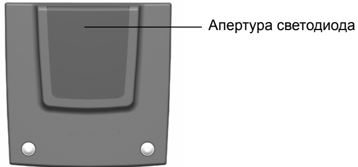
Рисунок 6.6. Апертура светодиода идентификатора цели
