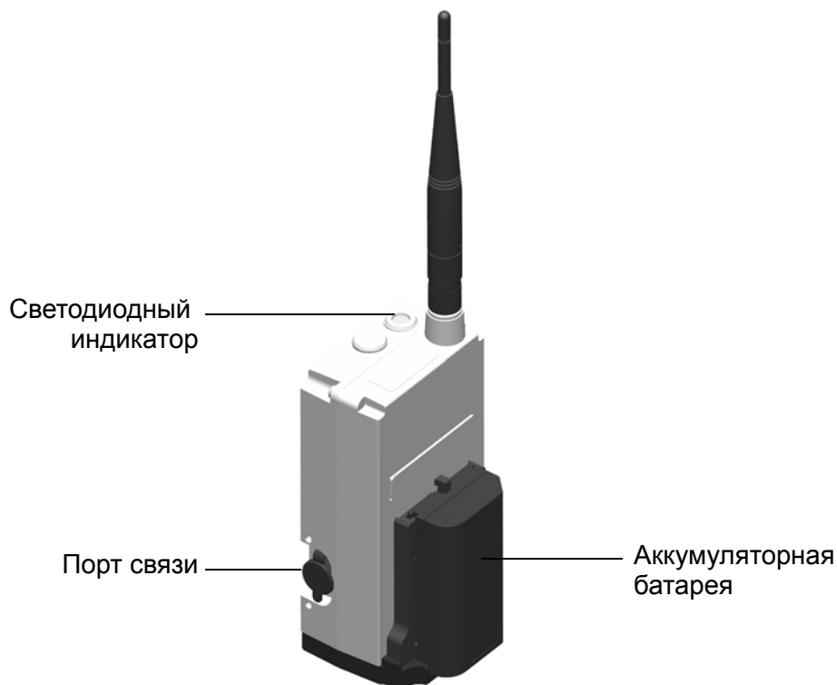
Рисунок 6.25. Внешний 2,4-ГГц радиомодем
