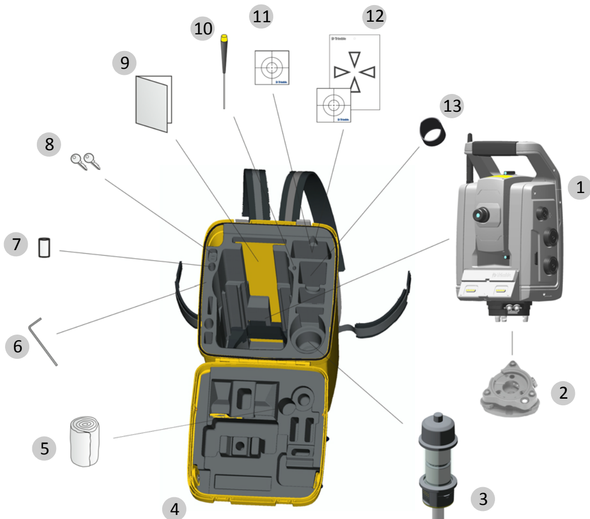
Рисунок 2.1. Расположение предметов в футляре инструмента
