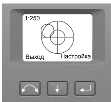
Рисунок 3.11. Страница нивелировки с электронным уровнем на дисплее КП
