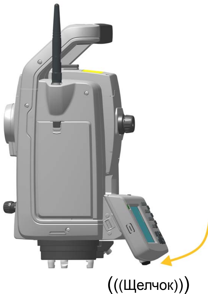
Рисунок 4.13. Установка TCU на инструмент
