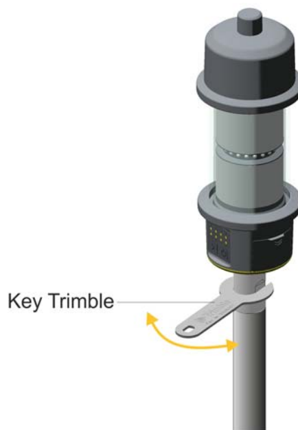
Рисунок 6.17. Установка и снятие цели Trimble Active Track 360
