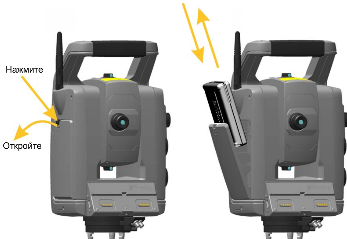
Рисунок 3.7. Установка и извлечение внутренней батареи
