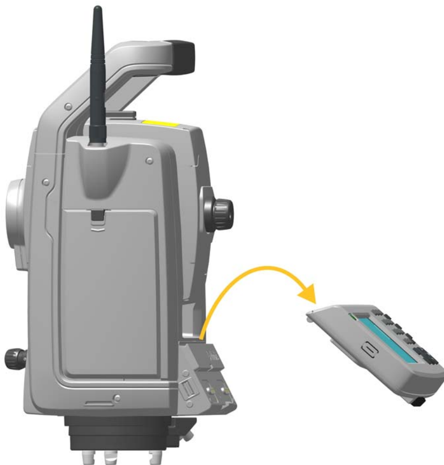
Рисунок 4.15. Снятие TCU с инструмента
