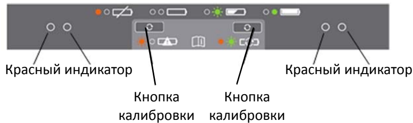
Рисунок 3.6. Панель управления зарядного устройства на две батареи
