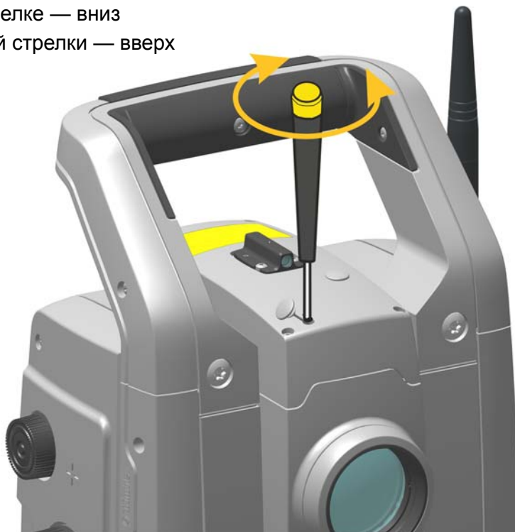
Рисунок 4.6. Юстировка положения лазерного указателя по вертикали
