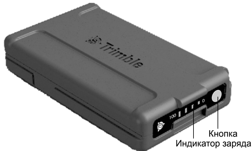
Рисунок 3.1. Индикатор заряда и кнопка батареи
